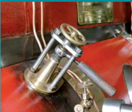
Uma das válvulas de admissão de vapor na máquina Joseph Farcot . © EMS/CDI, Rosa Reis, 2007
